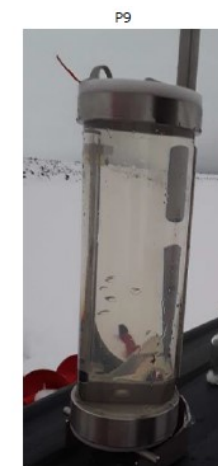
Kuva alla. Suojaverho erottaa hyvin samentuneen veden
